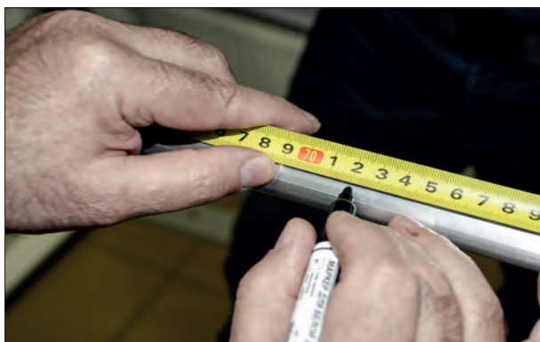
16. Прибавить к измеренному 30 мм и отрезать балку. В нашем случае длина балки составляет 720 мм. Отрезать балку.
