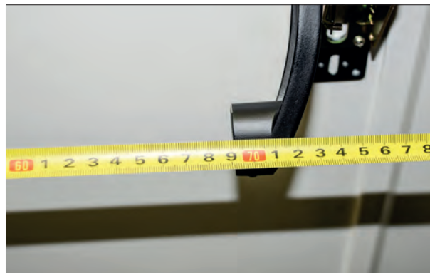
15. В нашем случае длина видимой части нажимной балки составляет 690 мм.
